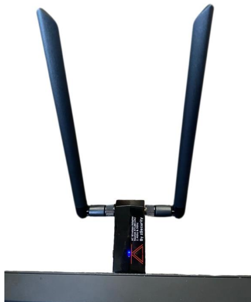
Slika 26: Primjer Wi-Fi adaptera koji je korišćen u istraživanju
